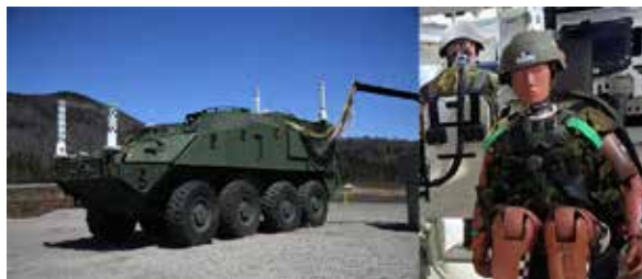
Véhicule blindé de soutien au combat muni de tours repères servant à l'imagerie et à la métrologie pour capter des données et prendre des mesures aux fins d'analyse à la suite de la détonation, et mannequins installés dans le compartiment de l'équipage. Crédit photo : Jean Michaud, technicien en imagerie
