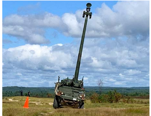
Le mât en pleine extension en mouvement durant les essais à Petawawa.
