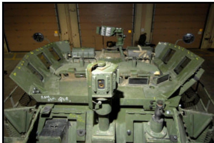
Vue de la plage arrière du Coyote équipé avec les prototypes de boucliers, miroirs et d'affût flexible.
