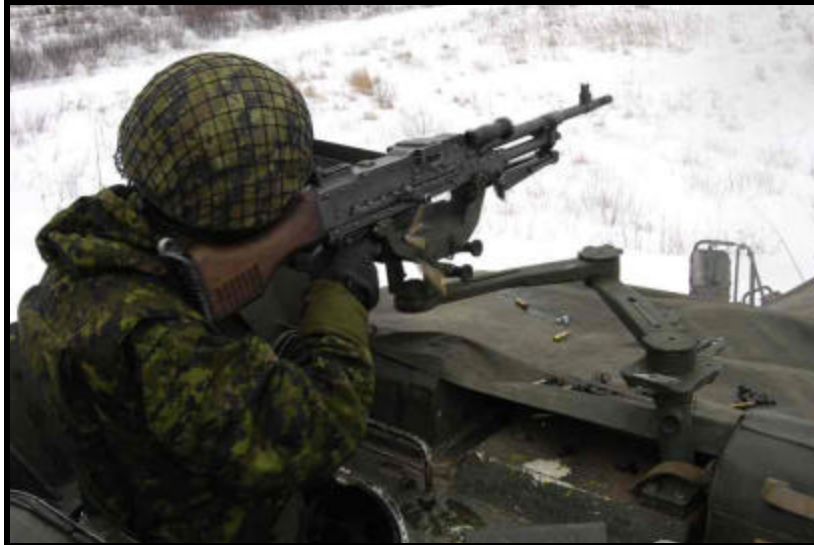
Prototype de l'affût flexible de la mitrailleuse polyvalente employé par le tireur du Coyote.
